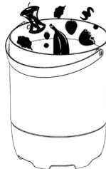
3. Lorsque le seau est rempli jusqu'à la ligne de remplissage et prêt à être traité, insérez le seau dans la partie principale. Il se peut que vous deviez tordre légèrement le seau jusqu'à ce qu'il se mette en place correctement.
